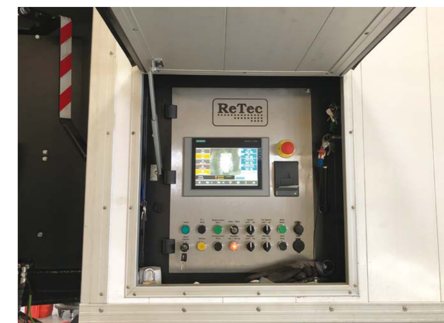
Steuerung mittels Touchdisplay mit integriertem Wiegesystem und Klartextanzeige über Betriebszustände.
